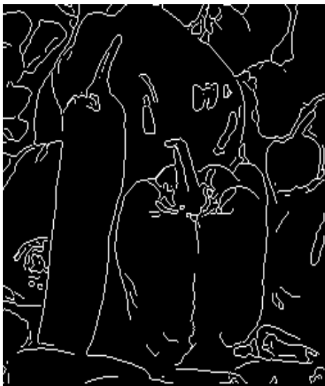
Fig. 3: Result using Bergholm Edge Detector.
