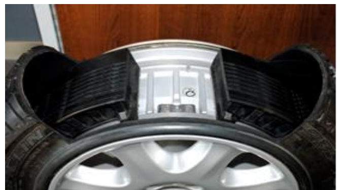
Fig. 2. BMW Run Flat Tyre Courtesy: nl.wikipedia.org
