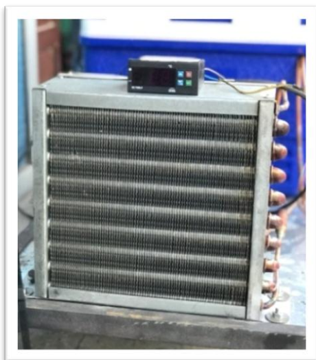
Fig: 3. Actual Air-cooled condenser
